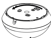
Figura 2. Remoção do suporte
